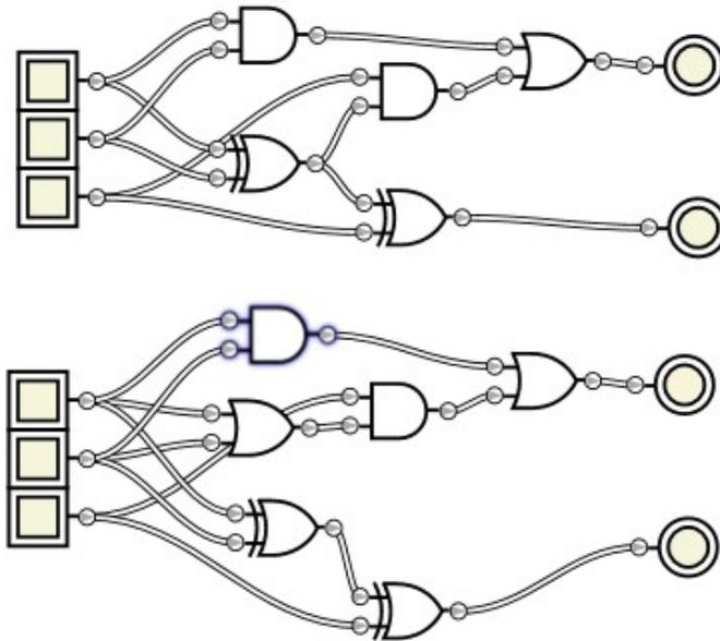
Il primo circuito a cammino critico pari a 3 e complessità pari a 5. Il secondo cammino critico 3 e complessità 6. Da un'ispezione della tabella di verità si può notare che i due circuiti realizzano entrambi un sommatore Full-Adder.
